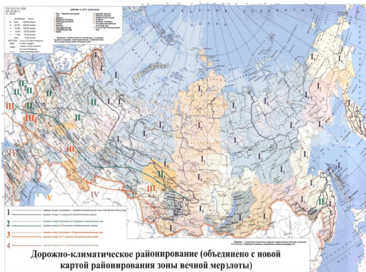
Рисунок 2 - Схематическая карта дорожно-климатического районирования зоны вечной мерзлоты
