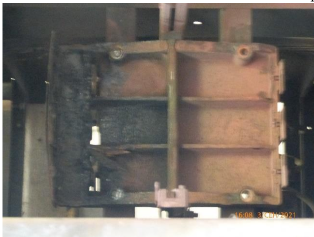
Автоматический выключатель 0,4 кВ, на котором произошло короткое замыкание.
