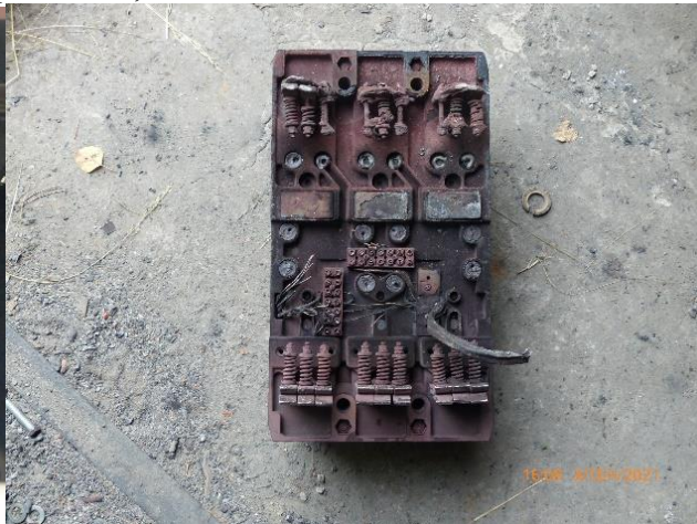
Автоматический выключатель 0,4 кВ, на котором произошло короткое замыкание.
